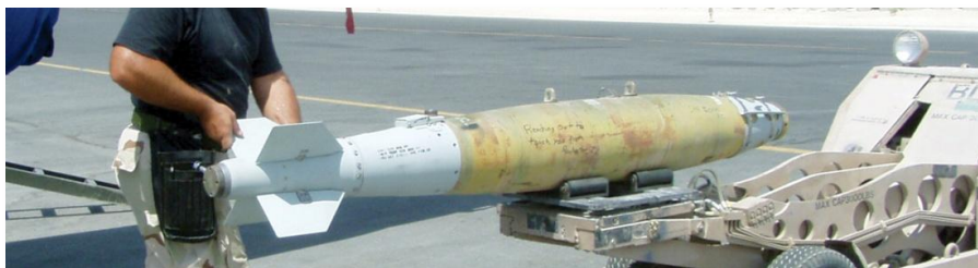
Рис 57. Авиабомба GBU-38 с инерциальным наведением.
