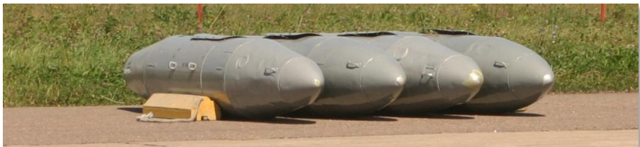
Рис. 67. Транспортный контейнер MXU-648.
