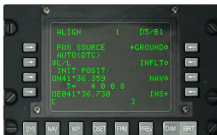
Рис. 131. Подстраница System / INS / ALIGN.
