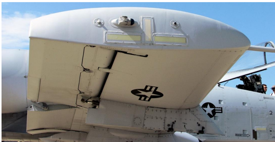
Рис. 35. Законцовка крыла и элерон.
