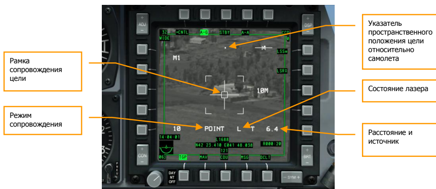
Рис. 396. Сопровождение цели в режиме Point.
