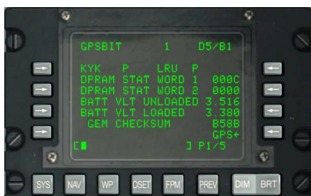
Рис. 140. Подстраница System / GPS / GPSBIT 1.
