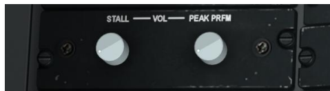
Рис. 108. Панель управления системой предупреждения о сваливании.
