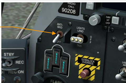
Рис. 30519. Панель SAS и выключатель антиблокировочной системы.
