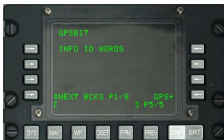
Рис. 144. Подстраница System / GPS / GPSBIT 5.
