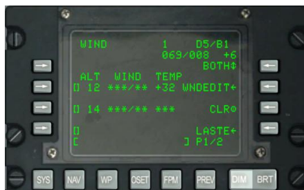
Рис. 149. Подстраница System / LASTE / WIND.
