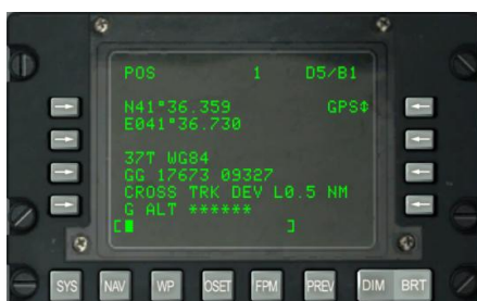
Рис. 133. Подстраница System / INS / POS.
