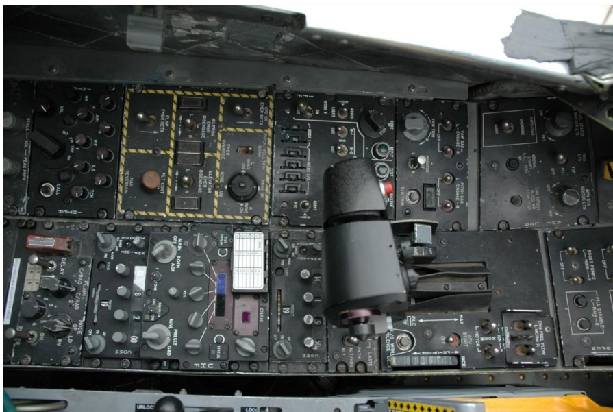
Рис. 38. Левая консоль с УКВ и КВ радиостанциями.
