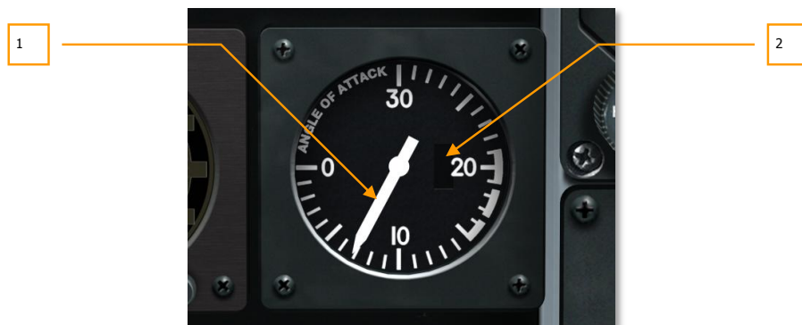
Рис. 76. Указатель угла атаки.
