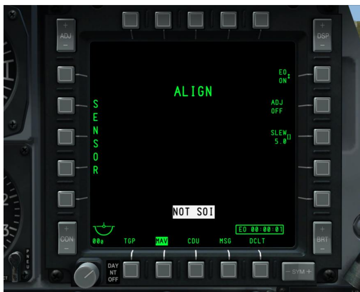
Рис. 243. Страница Maverick, согласование гироскопов.
