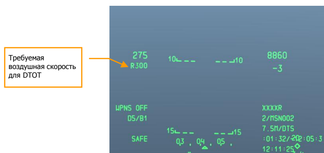
Рис. 364. Индикация на HUD требуемой воздушной скорости.
