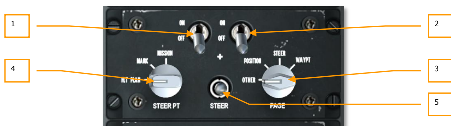
Рис. 117. Вспомогательная панель авионики (AAP).
