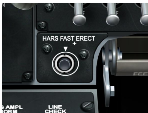
Рис. 82. Кнопка быстрого выравнивания резервной курсовертикали.
