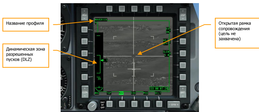
Рис. 419. Ракета Maverick в боевом режиме, без сопровождения.
