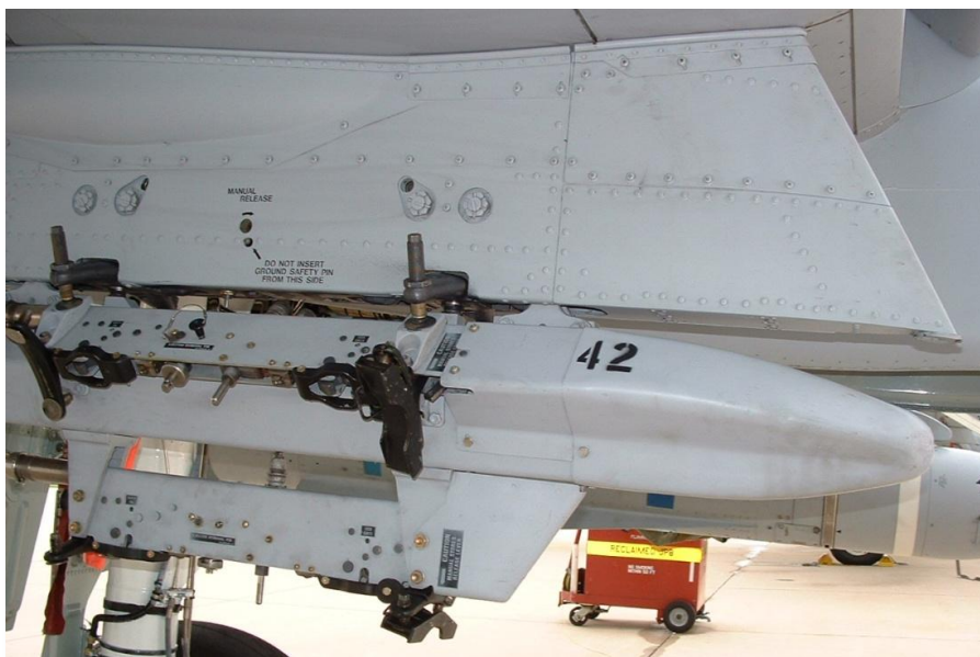
Рис. 43. Трёхрамковый балочный держатель BRU-42.
