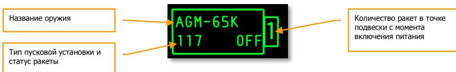
Рис. 413. Точка подвески с ракетами Maverick, питание выключено.
