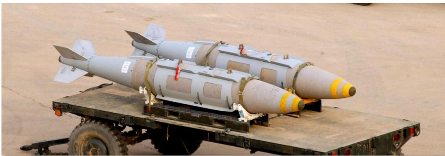
Рис 58. Авиабомба GBU-31 с инерциальным наведением.
