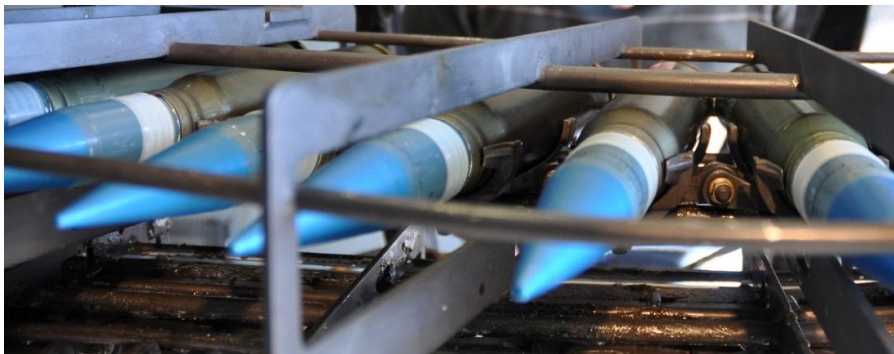
Рис. 41. 30 мм снаряды GAU-8/A.
