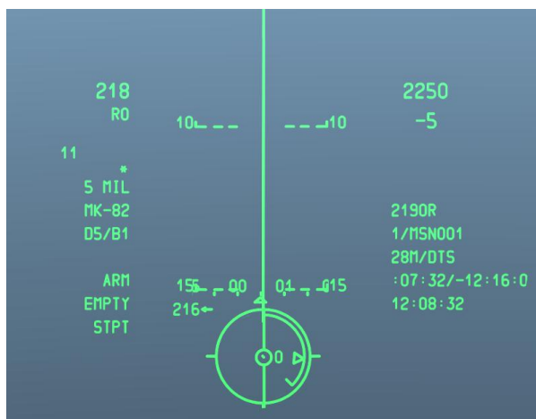
Рис 258. Момент сброса бомб в режиме CCIP CR.
