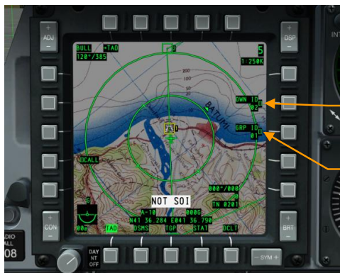
Рис. 3171. Страница конфигурации сети передачи данных.
