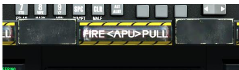
Рис. 85. Т-образная рукоятка тушения пожара ВСУ.
