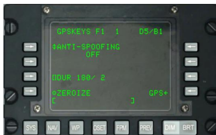
Рис. 145. Подстраница System / GPS / GPKEYS.
