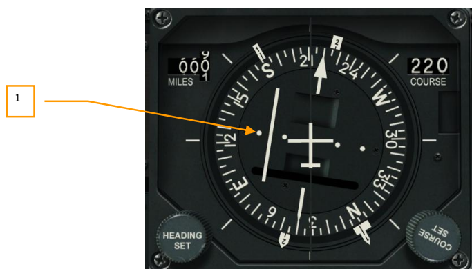
Рис. 32469. Расположение глиссады на ПНП.
