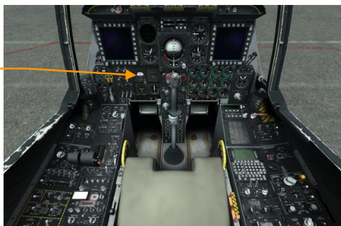
Рис. 338. Разарретирование резервного авиагоризонта.
