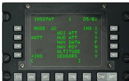
Рис. 134. Подстраница System / INS / INSSTAT.
